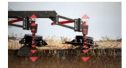
Die gleichmäßig flache Bearbeitung stellt die parallelogrammgeführte Aufhängung der Werkzeuge sicher. Durch die federbelasteten Messerwerkzeuge und das speziell entwickelte Druckentlastungssystem im Rotor wird eine gute horizontale und vertikale Führung der Arbeitswerkzeuge erreicht. Erst damit wird eine wesentlich verbesserte Boden Anpassung als bei bisherigen Konzepten möglich.
