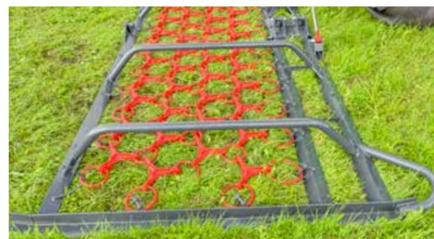
Die in vier Reihen angeordneten W-Gußelemente garantieren eine optimale Arbeitsleistung. Die Gußelemente sind beidseitig verwendbar: Zinkseite für scharfes Eggen und Belüften der Grasnarbe, Glattseite zum Verteilen von Kuhfladen und Einebnen von Maulwurfshaufen. Die Grünlandeggen Perfekt W4 verfügen über zwei hintereinander angeordnete Winkeleisen in der Front der Maschine, diese sorgen für einen Zwangseinebnungseffekt von Maulwurfshügeln und Unebenheiten.
