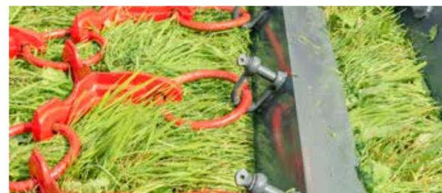
Die vordere und seitliche Fixierung des Netzes erfolgt durch Schäkel. Dadurch wird ein unbeabsichtigtes Aushängen des Netzes verhindert.
