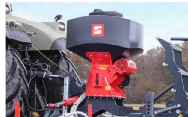
Optional ist das Gerät mit einem SAPHIR DrillStar ausrüstbar. Dieser ermöglicht eine sehr exakte und windunanfällige Nachsaat von Futtergräsern in geschädigten Beständen.
