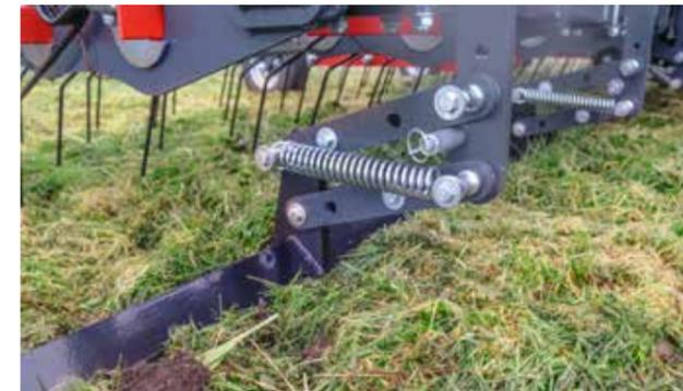
Mit der federbelasteten und parallelgeführten Impulsschiene lassen sich Maulwurfshaufen einebnen.
