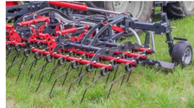
Das parallelgeführte, vierreihige Striegelfeld erlaubt einen Höhenausgleich von 100 mm. Dabei ist die Zinkenaggressivität der 10 mm Zinken paarweise einstellbar. Eine Zinkenverlustrsicherung ist ebenfalls serienmäßig verbaut.
