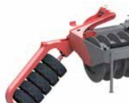
Optionaler Silagekantenverdichter (1 x dw erforderlich) zur Befestigung der freistehenden Silokanten
