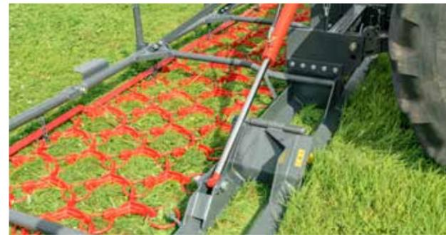
Durch den hochgezogenen Tragrahmen wird eine große Bewegungs-freiheit des Eggenetzes gewährleistet. Die vierreihig angeordneten S-Gußelemente garantieren eine hohe Arbeitsleistung. Die S-Gußelemente können von beiden Seiten verwendet werden: Scharfes Eggen und Belüften mit der Zinkenseite, einfaches Schleppen zum Einebnen von Maulwurfshaufen mit der Glattseite.
