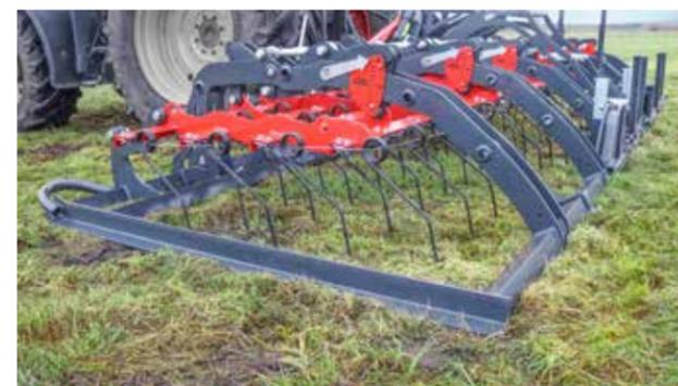
Die Striegelsegmente können bis zu 250 mm unter den starren Rahmen verstellbar werden. Somit kann der Grünlandstriegel ebenfalls zur weiteren Auslastung genutzt werden, indem die Maschine in der Hydraulik gehalten wird. Sowohl zur effektiven Aussaat von Zwischenfrüchten, als auch zur Unkrautbekämpfung unmittelbar nach der Aussaat der Hauptfrucht (Blindstriegeln).
