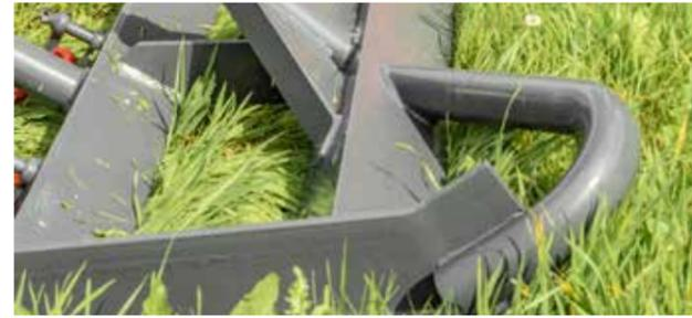
Die Grünlandeggen Perfekt S4 verfügen über zwei hintereinander angeordnete Winkeleisen in der Front der Maschine, welche für eine vollständige Zwangseinebnung von Unebenheiten und Maulwurfs-haufen sorgen. Das reduziert den Verschleiß der darauffolgenden Erntetechnik und senkt die Grundfutterverschmutzung.
