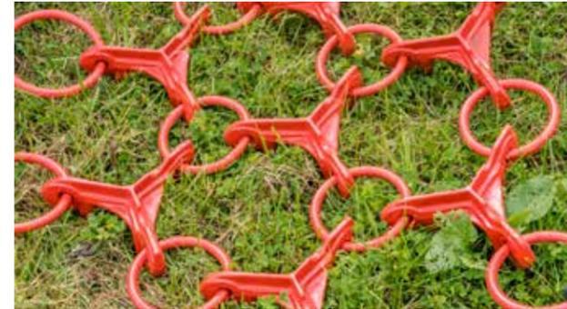
Das dreireihige Netz mit den ca. 2,5 kg schweren W-Gußsternen garantiert eine intensive Bearbeitung in nur einer Überfahrt. Die schweren W-Gußsterne können von beiden Seiten verwendet werden: Scharfes Eggen und Belüften mit der Zinkenseite, einfaches Schleppen zur Einebnung von Kuhfladen und Maulwurfshäufen mit der Glattseite.
