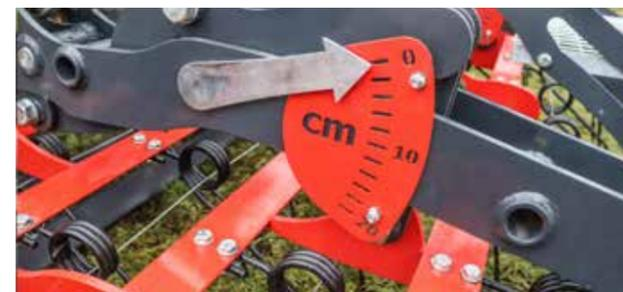
Die serienmäßigen Skalierungen an den Zinkenfeldern ermöglichen eine gleichmäßige Striegelintensität auf der gesamten Arbeitsbreite.
