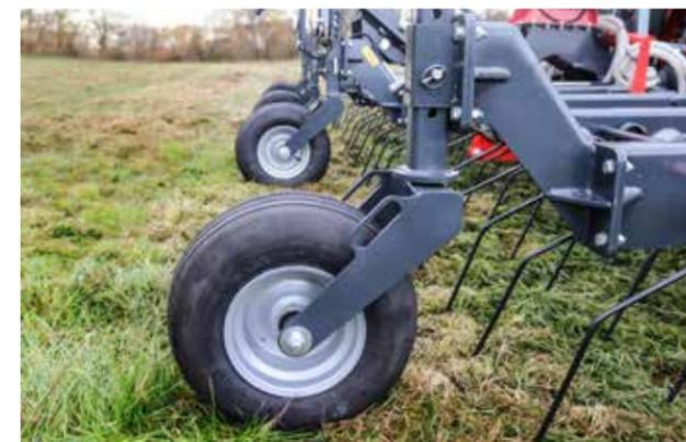
Nachlaufende Stützräder (luftbereift, frei drehend 360°) sorgen für eine optimale Boden Anpassung und einen ruhigen Lauf.
