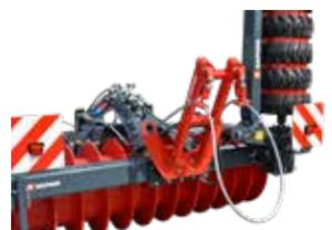
Optionale Schleppvorrichtung (1 x dw erforderlich) zur Schlepphilfe der Transportfahrzeuge für besonders hohe Fahrhilfen
