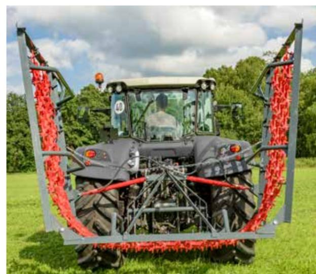
Optionale hydraulische Klappung zum Einklappen der Geräte in Transportstellung. Beim Modell Perfekt 602 W4 ist die hydr. Klappvorrichtung serienmäßig im Lieferumfang enthalten.
