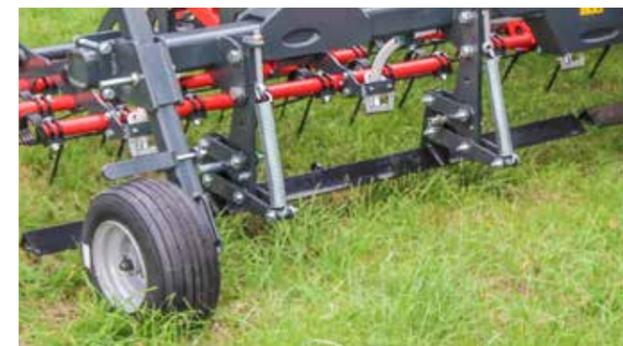
Mit der federbelasteten und parallelgeführten Impulsschiene lassen sich Flurschäden besonders nabenschonend eibeben
