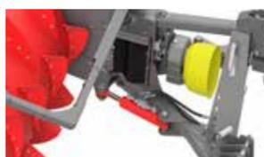
Optionales Wendegetriebe für wahlweise Nutzung im Front- oder Heckanbau
