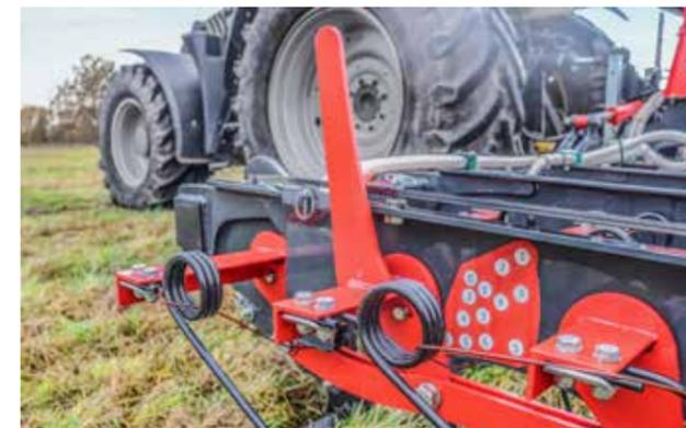
Der Exaktstriegel Perfekt ES verfügt über drehbare Zinken-träger. Die Verstellung der Zinkenagressivität erfolgt mechanisch per Lochraster.
