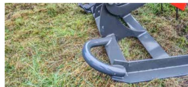
Die Winkeleisen des Rahmens sorgen für eine optimale Einebnung von Maulwurfshäufen. Gleichzeitig erfolgt eine Verteilung von Kuhfladen und organischen Rückständen.
