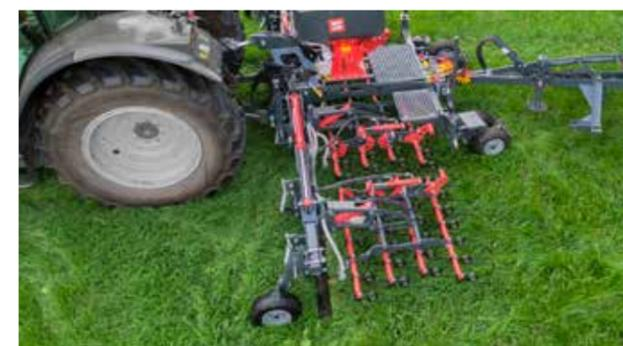
Die vorderen luftbereiften Stützräder sorgen für eine hohe Laufruhe und sind per Lochraster einstellbar. Die nachlaufenden, 60° schwenkbaren doppelbereiften Stützräder reduzieren die Stützlast, speziell bei angehangener Walze. Vorne und hinten sind die Stützrädern mit einem Schutzabweiser ausgestattet.
