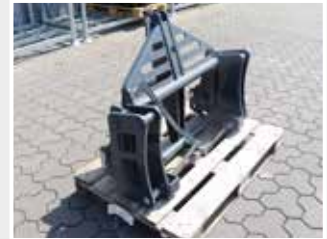
Adapterrahmen Kat. II / Volvo L40 Lagermaschine Bj. 2023; Dreipunktaufnahme Kat. II; Geräteaufnahme Volvo L40; Farbschäden
