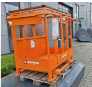
Arbeitsbühne ABB 1 Lagermaschine Bj. 2023; Gabelzinkenaufnahme 120x50 mm oder 170x90 mm; Innenmaße 1.240 x 1.100 mm; Holzkantenschutz; für max. zwei Personen; Tragkraft max. 250 kg; Farbschäden
