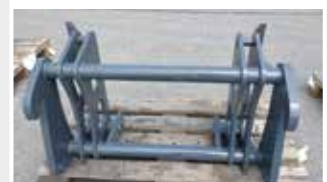
Adapterrahmen Volvo L30 / Volvo L20 Lagermaschine Bj. 2022; Fahrzeugaufnahme Volvo L30/Claas Torion/CAT/Case/Liebherr/Zettelmeyer; Geräteaufnahme Volvo L20/JCB 406
