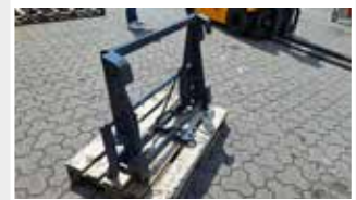
Adapterrahmen Merlo ZM3 / Euro Lagermaschine Bj. 2023; Fahrzeugaufnahme Merlo ZM3; Geräteaufnahme Euroaufnahme; Farbschäden
