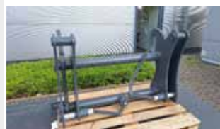
Adapterrahmen JCB Q-Fit / Volvo L70 Lagermaschine Bj. 2023; Fahrzeugaufnahme JCB Q-Fit; Geräteaufnahme Volvo L50-L120/Claas/CAT/Case/Liebherr; Farbschäden
