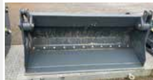
KS 19 Volvo L30 Klappschaukel Vorführmaschine Bj. 2021; Fahrzeugaufnahme Volvo L30/Claas Torion/CAT/Case/Liebherr/Zettelmeyer; Breite 1.900 mm; Öffnungsweite 1.020 mm; Inhalt nach DIN 440 l; Farbschäden
