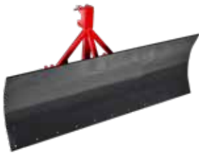
RS 2500 Räumschild Lagermaschine Bj. 2023; Dreipunktaufnahme Kat. I/II; Räumbreite 2.500 mm; Schildhöhe 710 mm; Farbschäden
