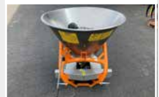
Salzstreuer PES 300 Profi Lagermaschine mit leichten Transport-schaden Bj. 2024; Behälter (270L), Streuteller und Profi-Streubreitenbegrenzer aus Edel-stahl; Dreipunktbau Kat. I; Gelenkwelle
