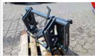
Adapterrahmen Euro / Schäffer SWH Lagermaschine Bj. 2022; Fahrzeugaufnahme Euroaufnahme; Geräteaufnahme Schäffer SWH; Farbschäden
