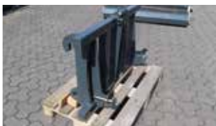
Adapterrahmen Claas Scorpion / Kat. II Lagermaschine Bj. 2023; Fahrzeugaufnahme Claas Scorpion/Kramer KT; Geräteaufnahme Dreipunkt Kat. II; Farbschäden
