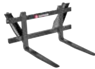
PG 11/25 Euro Palettengabel Lagermaschine Bj. 2023; Euroaufnahme; Gabelträgerbreite 1.200 mm; Gabelzinkenlänge 1.100 mm; Tragfähigkeit max. 2.500 kg; Farbschäden
