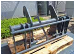
Adapterrahmen CAT IT / Euro Lagermaschine Bj. 2023; Fahrzeugaufnahme CAT IT; Geräteaufnahme Euro; Farbschäden
