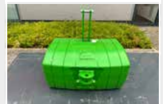
Stahlbetongewicht NG 400 kg Lagermaschine Bj. 2023, JD grün; Dreipunktbau Kat. II; Rangierkupplung; Farbschäden
