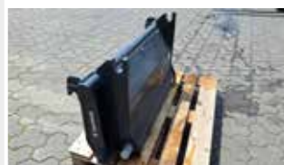
Adapterrahmen Euro / Schaeff SKL 833 (hydr. Verriegelung) Lagermaschine Bj. 2023; Fahrzeugaufnahme Euroaufnahme; Geräteaufnahme Schaeff SKL 833; hydraulische Geräteverriegelung; Farbschäden
