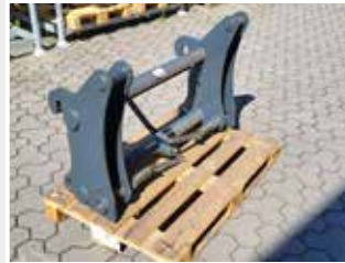
Adapterrahmen Claas Scorpion / Volvo L70 Lagermaschine Bj. 2023; Fahrzeugaufnahme Claas Scorpion/Kramer KT; Geräteaufnahme Volvo L50-L120/Claas/JCB/CAT/Case/Liebherr; Farbschäden
