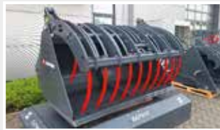
GS L 20Z Volvo L30 Greifschaukel Vorführmaschine Bj. 2023; Fahrzeugaufnahme Volvo L30/Claas Torion/CAT/Case/Liebherr/Zettelmeyer; Breite 2.000 mm Öffnungsweite 1.540 mm; Inhalt 1.750 l; Wendemesser 200x20 mm; Farbschäden
