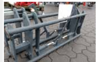
Adapterrahmen Terex TL 65 / Euro Lagermaschine Bj. 2023; Fahrzeugaufnahme Terex TL 65; Geräteaufnahme Euroaufnahme; Farbschäden
