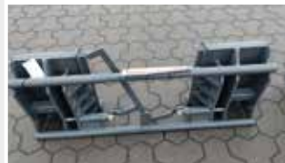
Adapterrahmen DIN 24410 / Euro Lagermaschine Bj. 2023; Fahrzeugaufnahme DIN 24410/SkidSteer; Geräteaufnahme Euroaufnahme; Farbschäden
