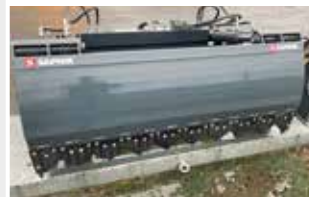
SSE 199 Volvo L30 Silageschneidschaukel Vorführmaschine Bj. 2021; Fahrzeugaufnahme Volvo L30/Claas Torion/CAT/Case/Liebherr/Zettelmeyer; Breite 1.990 mm; Öffnungsweite 850 mm; Inhalt 1.350 l; Farbschäden
