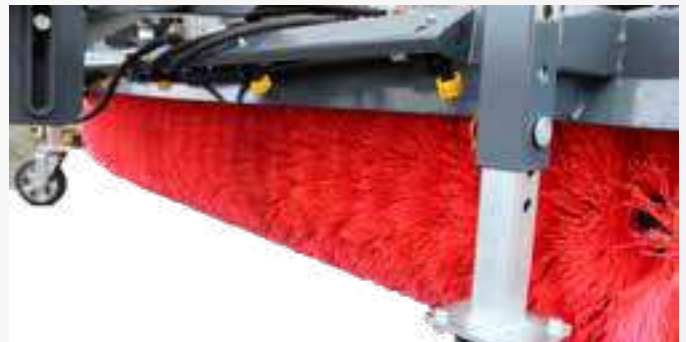
Wassersprüheinrichtung, um die Staubbildung beim Kehren zu mindern
