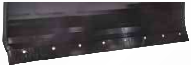
Geschraubte, hochverschleißfeste Schürfleiste (120 x 20 mm 500 HB)
