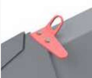
Beidseitige Sichtanzeige als Ori-entierungshilfe beim ebenerdigen Aufladen von Schüttgütern
