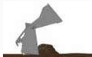
II. Planierarbeiten mit geöffnetem Schaufelkörper
