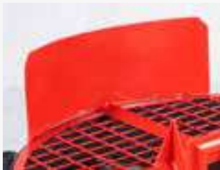
Vorderes Spritzblech zum Schutz des Traktors
