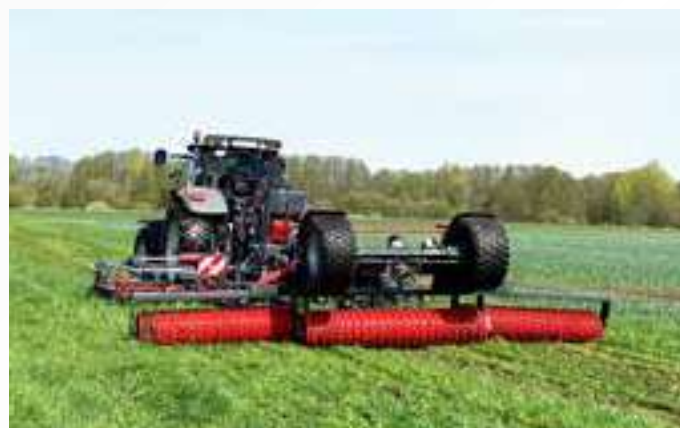
Konturstriegel Perfekt KS 600 mit angehangener Cambridgewalze
