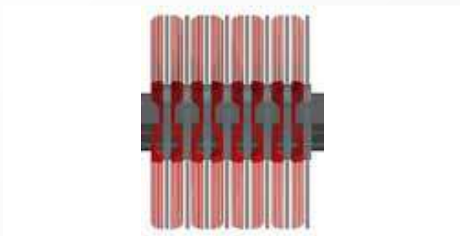
Optionaler Mischbesatz aus Kunststoff- und Metallbürstenringen
