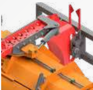
Verstellbarer Anbauturm zum Einstellen des Vorbaumaßes der Kehrmaschine
