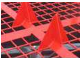
2 Aufreißerspitzen zum Öffnen von Säcken.
