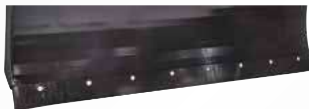
Geschraubte, hochverschleißfeste Schürfleiste (120 x 20 mm 500 HB)
