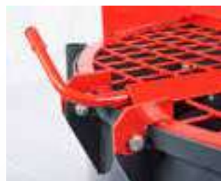
3/4" Anschluss zum Beimischen von Wasser
