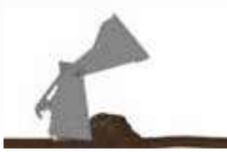
II. Planierarbeiten mit geöffnetem Schaufelkörper
