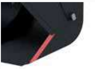
Eingeschweißte Gegenschneide seitlich in der Oberzange
