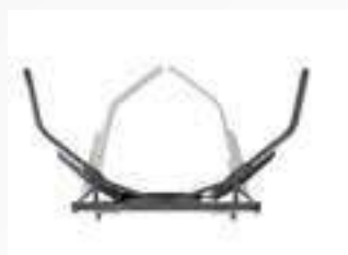
Parallelführung der Haltewangen
