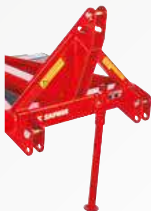
Front- und Heckanbau Kat. II mit stabiler Abstellstütze
