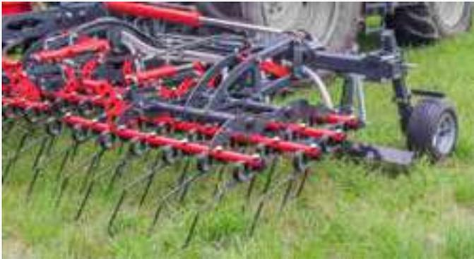
Das parallelgeführte, vierreihige Striegelfeld erlaubt einen Höhenausgleich von 100 mm.
