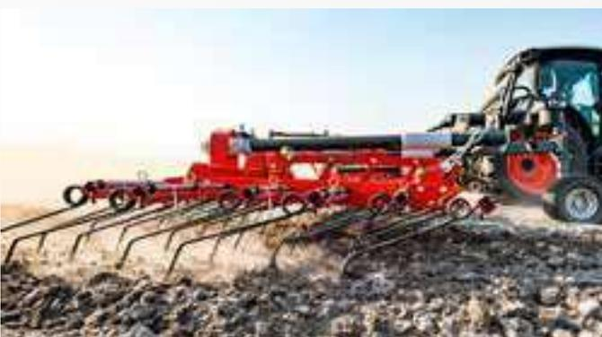
Die Zinken enterden zuverlässig die Wurzeln der herausgezogenen Beikräuter und -gräser. Das garantiert ein sicheres Vertrocknen und verhindert das erneute Anwachsen der Wurzeln. Die Selbstreinigung der Zinken ist durch deren hohes Vibrationsvermögen ebenfalls gegen Verstopfung unanfällig.
