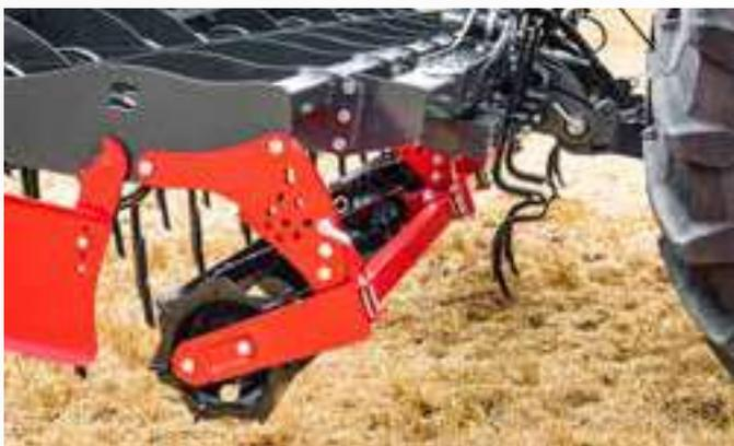
Vorlaufende Krümmerwalze 320 mm zur Einebnung des Bodens und Brechen größerer Kluten. In Kombination mit der nachlaufenden Walze dient sie zudem der gleichmäßigen Höhenführung des Gerätes. Alternativ kann ein mechanisches Balancerail für unebene Bodenstrukturen mit groben Kluten montiert werden.
