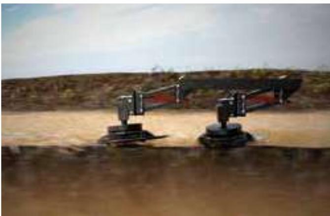
Die Rotoren werden ausschließlich durch die Vorfahrtsgeschwindigkeit angetrieben. Dadurch arbeitet das entwickelte Gerät nicht nur schneller (12 – 18 km/h), auch der Kraftstoffverbrauch pro Hektar sinkt deutlich, durch den geringen Zugkraftbedarf von ca. 20 PS je Meter Arbeitsbreite.
