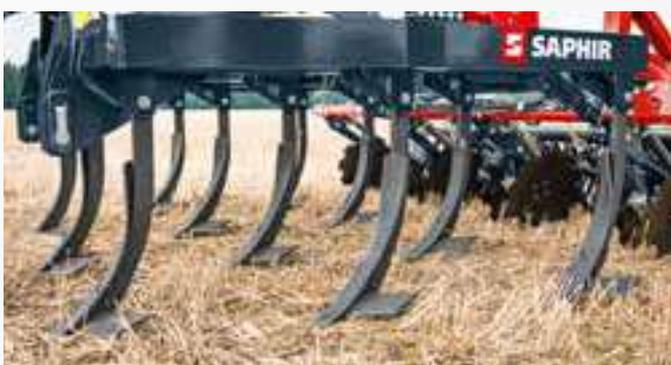
Die optimale Zinkenordnung und die Ausrichtung der Leitbleche bilden zusammen die bestmögliche Voraussetzung für einen verstopfungsfreien Durchgang und eine hervorragende Einmischung von Ernterückständen in den Boden. Mittels der Flügelschare (310 mm) kann ein ganzflächiger Unterschnitt der Bodenoberfläche erzeugt werden.
