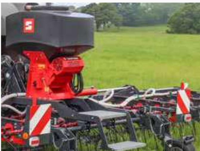
Optional ist das Gerät mit einem SAPHIR DrillStar ausrüstbar. Dieser ermöglicht eine sehr exakte und windunanfällige Nachsaat von Futtergräsern in geschädigten Beständen.
