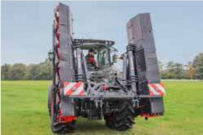
Unsere SAPHIR SinusCut 400, 500 & 600 Messerwalzen verfügen gegenüber dem 3 m Modell über eine hydraulische Klappung und über einen Front-Heck Anbaubock. Der serienmäßige Lenkbock sorgt dabei für optimale Fahreigenschaften im Frontanbau.
