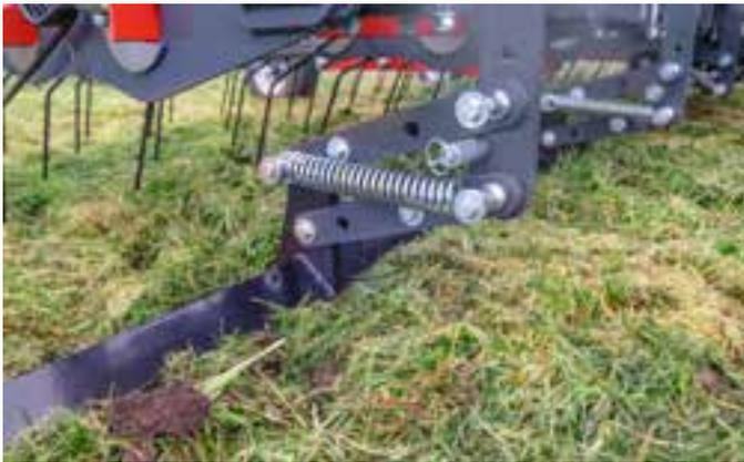
Mit der federbelasteten und parallelgeführten Impulsschiene lassen sich Maulwurfshaufen eibnen.
