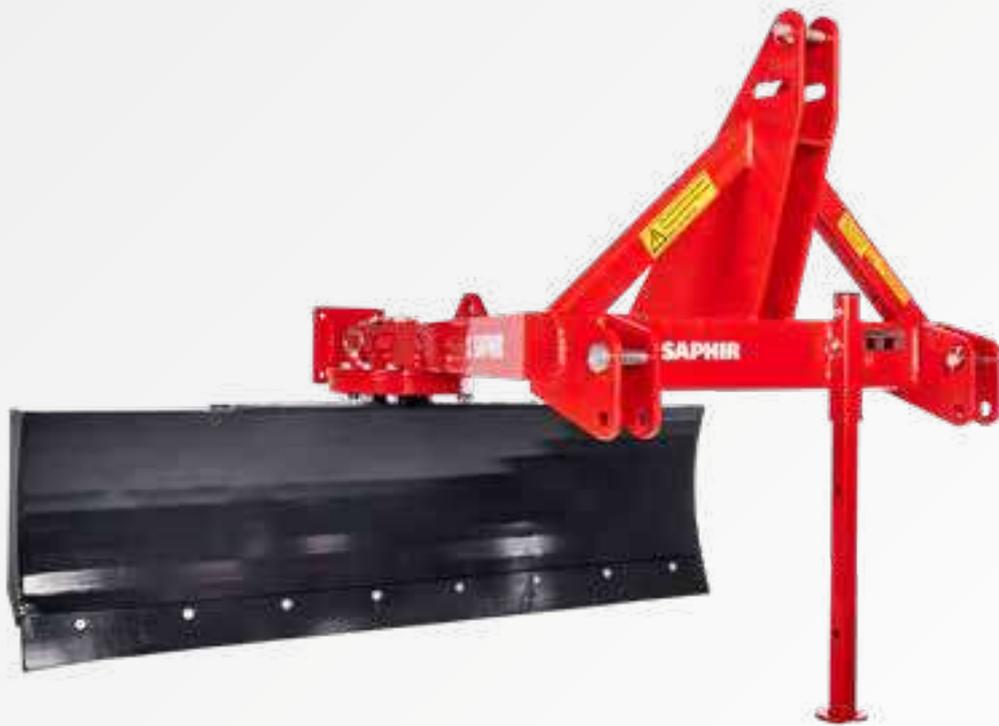
Die SAPHIR Planierschilder CONTOUR sind robuste, mechanisch verstellbare Schilder für leichte Planier- und Wegebauarbeiten mit Traktoren bis 73kW/100PS Leistung. Sie eignen sich außerdem für den Schneesräumeinsatz. Der Schildkörper kann serienmäßig um 360 Grad durchgeschwenkt werden. Somit kann das Schild auch im Frontanbau verwendet werden. Die Verriegelung erfolgt über einen Steckbolzen in Stufen von jeweils 22,5 Grad.
