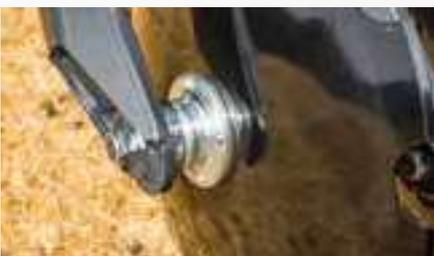
Geringer Verschleiß an den Scheiben durch geringe Kontaktflächen zum Boden und vollständigen Eigenantrieb der Scheibe. Es entsteht keine Reibung zwischen dem Scheibenrücken und dem Boden, wodurch der Verschleiß an der Scheibe minimiert wird. Die gezackten Hohl­scheiben mit einem Durchmesser von Ø 560 mm sind einzeln mit staubdichten und wartungsfreien Qualitätslagern montiert. Der Scheibenabstand beträgt 250 mm.
