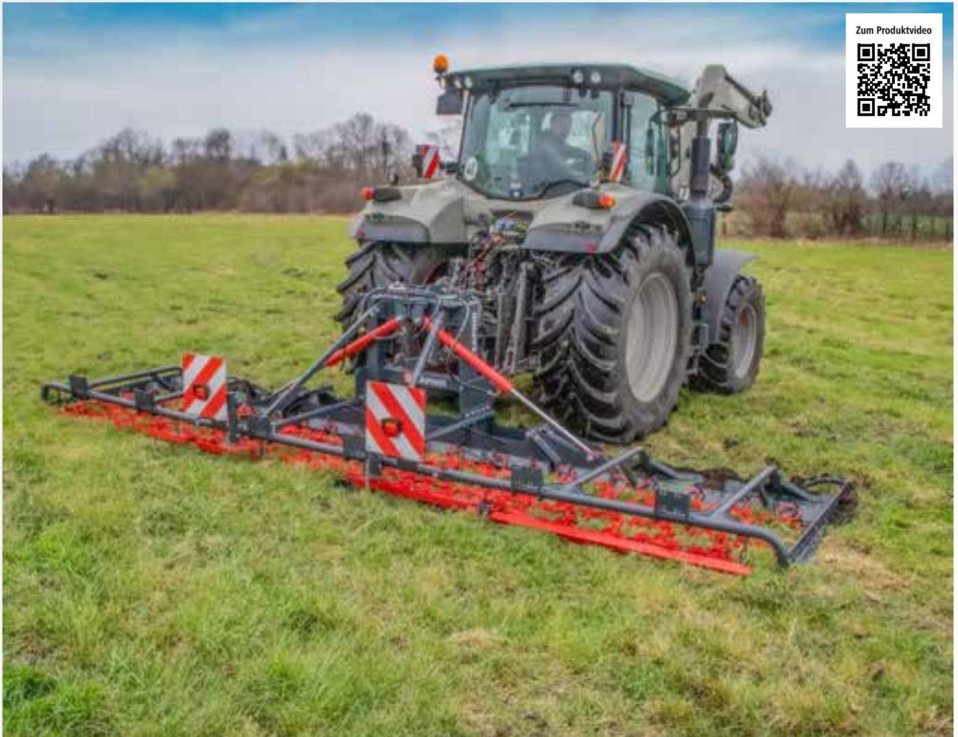
Die SAPHIR Grünlandegge Perfekt S4 garantiert durch einen besonders robusten Anbaubock und Rahmen eine maximale Stabilität. Der hochgezogene Tragrahmen ermöglicht durch das freihängende Netz eine sehr gute Boden-anpassung und damit optimale Arbeitsqualität. Durch den hochgezogenen Tragrahmen kann ausgekämmtes Material oder Festmistrückstände die Maschine problemlos passieren.
