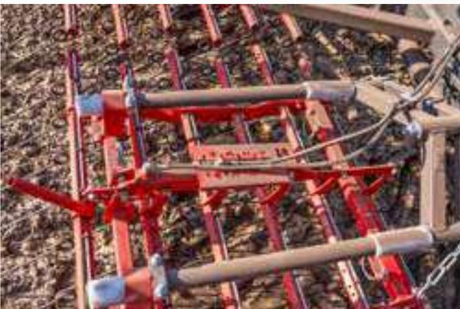
Das 3D-Zinkenfeld bietet so die perfekte Anpassung der Zinken an den Boden. Die Führung ermöglicht den Jet-Effekt um erst die hinteren und dann die vorderen Zinken in Eingriff zu bringen.
