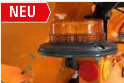
Optional: Das Beleuchtungspaket Plus beinhaltet neben den Arbeitsscheinwerfern auch eine Rundumleuchte und eine Innenraumbeleuchtung des Behälters.
