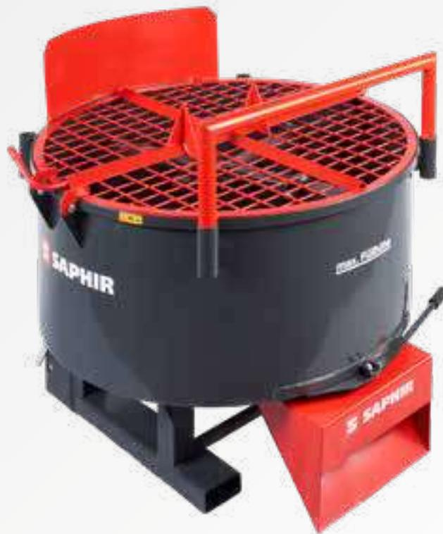
Der SAPHIR Betonmischer Mammut ist geeignet zum Mischen von Beton, Estrich, Mörtel, Getreide, Dünger, Torf und Erde. Die vier gefederten Mischarme garantieren eine schnelle, homogene Mischung aller zugegebenen Komponenten. Der SAPHIR Betonmischer verfügt über eine **Dreipunktaufnahme Kat. II**, sowie **Einfahrtaschen für Gabelzinken (Tascheninnenmaß: 180 x 60 mm)**. Optional ist ein hydraulischer Antrieb erhältlich.
