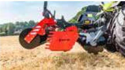
Der hohe Durchgang der Scheiben ermöglicht eine sehr kompakte Bauweise der Maschine. Dadurch können in der Dreipunkt getragene Kurzscheibeneggen mit hohen Arbeitsbreiten durch Schlepper geringerer Leistungsklassen gefahren werden. Die Vorderachsbelastung ist gering. Dadurch wird die Effizienz des Schleppers enorm gesteigert.
