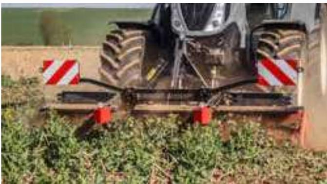
Neben dem klassischen Einsatzbereich zur Maiszünslerbekämpfung, decken unsere Messerwalzen ein breites Spektrum in der Zerkleinerung, z. B. von Rapsstoppeln, winterharten Zwischenfrüchten oder Sonderkulturen ab. Ebenso erzeugt das Gerät durch die Minimalbearbeitung etwas Feinerde, und sorgt somit für bessere Auflaufbedingungen für Ausfallraps.
