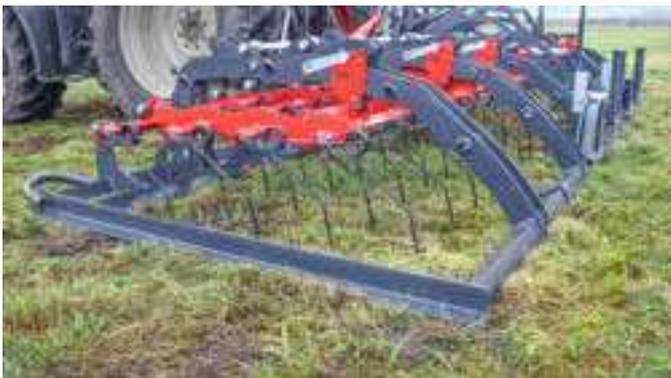
Die Striegelsegmente können bis zu 250 mm unter den starren Rahmen verstellt werden. Somit kann der Grünlandstriegel ebenfalls zur weiteren Auslastung genutzt werden, indem die Maschine in der Hydraulik gehalten wird. Sowohl zur effektiven Aussaat von Zwischenfrüchten, als auch zur Unkrautbekämpfung unmittelbar nach der Aussaat der Hauptfrucht (Blindstriegeln).
