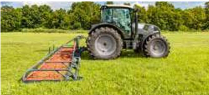
Der besonders robuste Rahmenaufbau besteht aus einem schweren Dreipunktturm und verstärkten Breitband-Klappschanieren. Die Unter- und Oberlenkerbolzen sitzen in stabilen Aufnahmetaschen.
