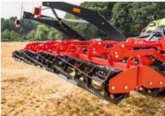
Die nachlaufende Doppelkrümmerwalze ebnet den obersten Bodenhorizont ein und hinterlässt eine besonders feinkrümelige Bodenstruktur. Weiterhin findet eine Rückverfestigung der unteren Bodenhorizonte zur Wiederherstellung der Kapillarwirkung statt.
