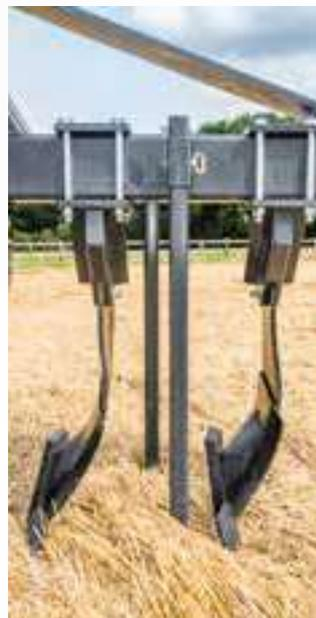
Die speziell geformten Schare heben den Unterboden an und lockern ihn dadurch auf der gesamten Arbeitsbreite. Anlagebleche und Scharspitzen können bei Verschleiß einzeln ausgetauscht werden.
