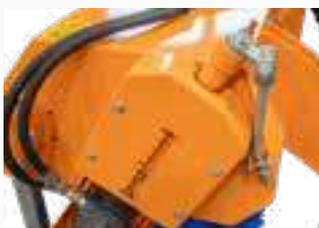
Die vertikale Verstellmöglichkeit der Kehrwalze sichert einen optimalen Abstand der Bürsten zur optionalen Sammelwanne
