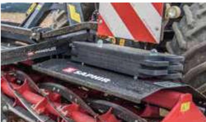
Die optionalen Zusatzgewichte bei der SinusCut 300 erhöhen das Gewicht der Maschine, wodurch ein effektiver Schnitt auch bei harten Bodenverhältnissen erreicht werden kann.
