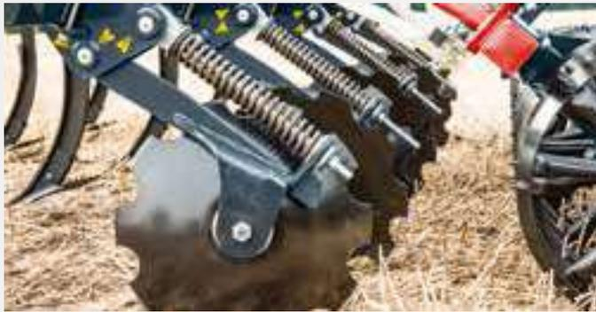
Die Einebnung von Unebenheiten und Einarbeitung von Ernterückständen erfolgt serienmäßig über Nivellatoren. Optional sind gefederte Hohl­scheiben lieferbar, deren Lager dauerhaft geschmiert sind und keinerlei Wartung benötigen.
