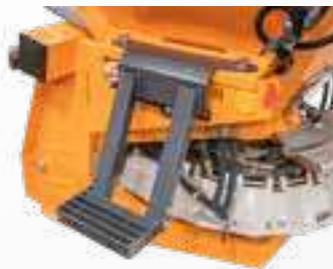
Optional: Der seitliche Aufstieg wird besonders bei Behälteraufsätzen empfohlen.
