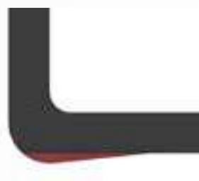
Zinken mit Verschleißschutz im Knickbereich
