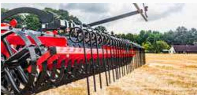
Der Nachstriegel dient der mechanischen Bekämpfung von Wurzelunkräutern. Diese werden ausgekämmt und zur Austrocknung auf den Boden abgelegt. Zudem wird der Bodenhorizont gekrümelt, um das Auflaufen von Ausfallgetreide zu verbessern.
