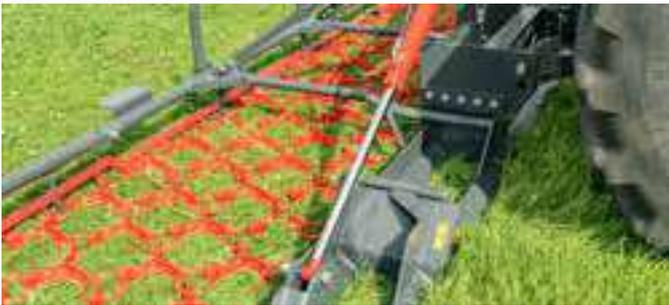
Durch den hochgezogenen Tragrahmen wird eine große Bewegungsfreiheit des Eggennetzes gewährleistet. Die vierreihig angeordneten S-Gußelemente garantieren eine hohe Arbeitsleistung. Die S-Gußelemente können von beiden Seiten verwendet werden: Scharfes Eggen und Belüften mit der Zinkenseite, einfaches Schleppen zum Einebnen von Maulwurfshäufen mit der Glattseite.
