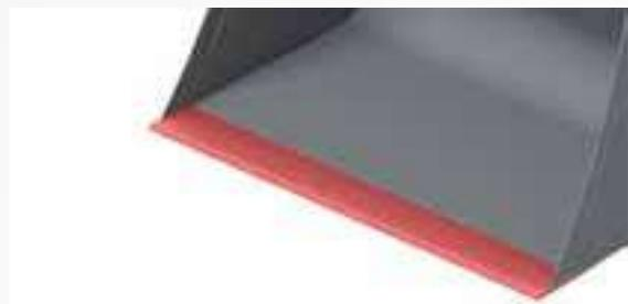
Erdschaufel und Kotgangschaufel sind ausgerüstet mit einer hochverschleißfesten Schürfleiste 150 x 16 mm (500 HB)
