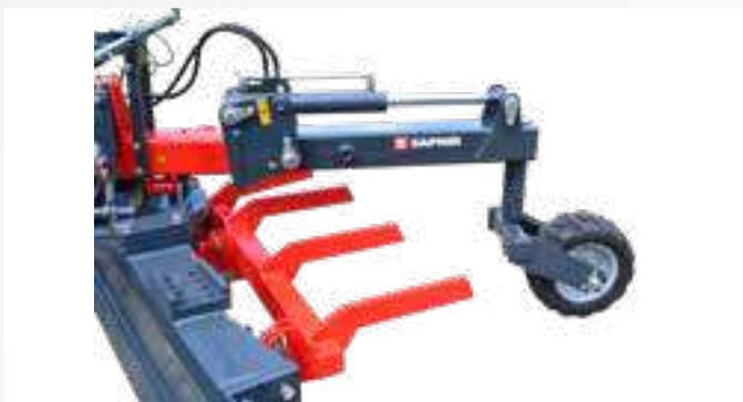
Mit dem hydraulischen Zentralstützrad (18x8.50-10) kann die Arbeitstiefe stufenlos hydraulisch eingestellt werden. Zum Transport kann es komplett senkrecht hochgeklappt werden.
