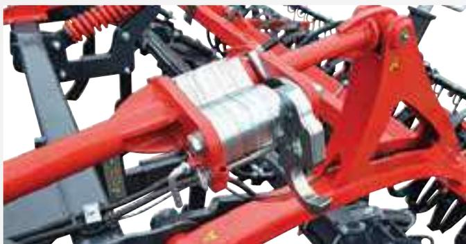
Die Arbeitstiefe des TineStar Profi wird über die mech. Tiefenverstellung eingestellt. Mittels Clips wird der nachlaufende Packer fest fixiert. So stützt sich der Grubber auf der Walze ab. Unter besonders trockenen und harten Bedingungen lässt sich das Gewicht der Nachlaufwalze auf den Grubberrahmen verlagern. Statt der mech. Tiefenverstellung gibt es optional eine hydraulische Variante. Mit Hilfe von zwei Hydraulikzylindern kann die Arbeitstiefe bequem variiert werden.
