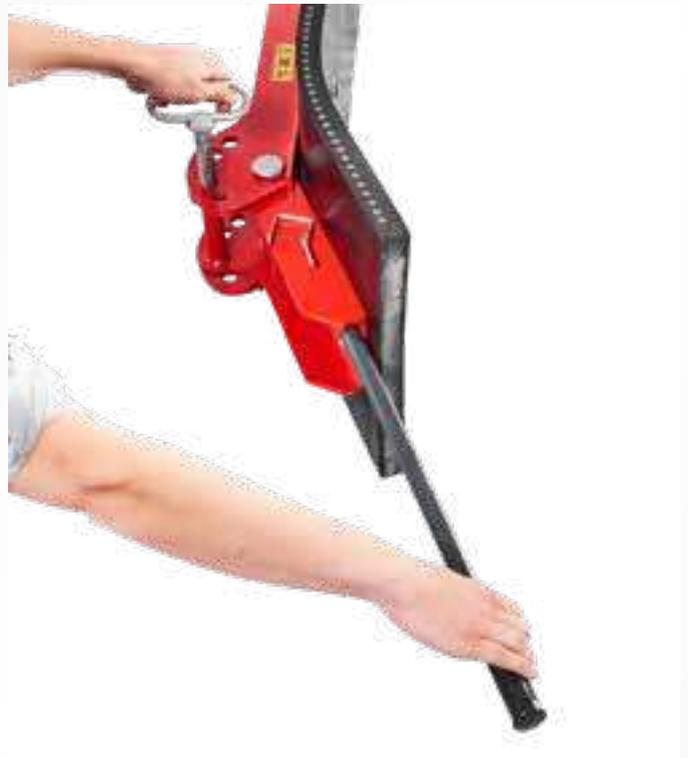
Seitenteile mechanisch anhand mitgeliefertem Montierhebel bedienerfreundlich schwenkbar
