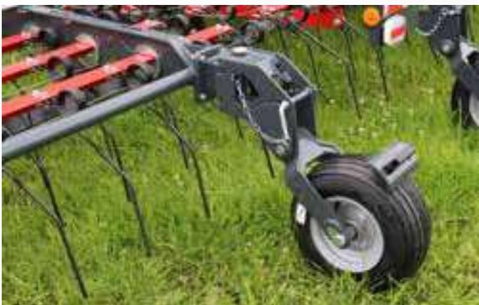
Nachlaufende Stützräder (luftbereift, frei drehend 90°) sorgen für eine optimale Boden Anpassung und einen ruhigen Lauf.
