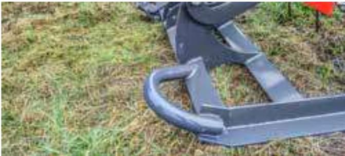
Die Winkeleisen des Rahmens sorgen für eine optimale Einebnung von Maulwurfshäufen. Gleichzeitig erfolgt eine Verteilung von Kuhfladen und organischen Rückständen.
