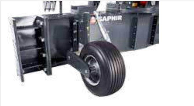
Die luftbereiften Stützräder (16x6.50-8) dienen der Höhenführung des Schildes. Die Höheneinstellung erfolgt über mechanische Drehspindeln.
