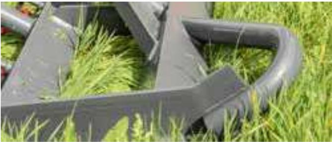
Die Grünlandeggen Perfekt S4 verfügen über zwei hintereinander angeordnete Winkelleisen in der Front der Maschine, welche für eine vollständige Zwangseinebnung von Unebenheiten und Maulwurfshäufen sorgen. Das reduziert den Verschleiß der darauffolgenden Erntetechnik und senkt die Grundfuttermverschmutzung.
