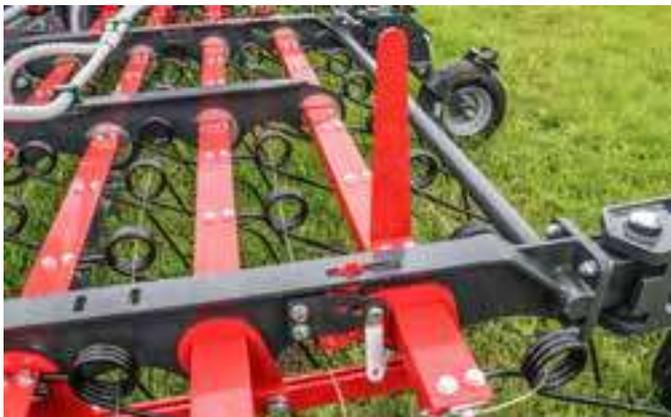
Der Exaktstriegel Perfekt ES verfügt über drehbare Zinkenträger. Die Verstellung der Zinkenaggressivität erfolgt mechanisch per Lochraster.
