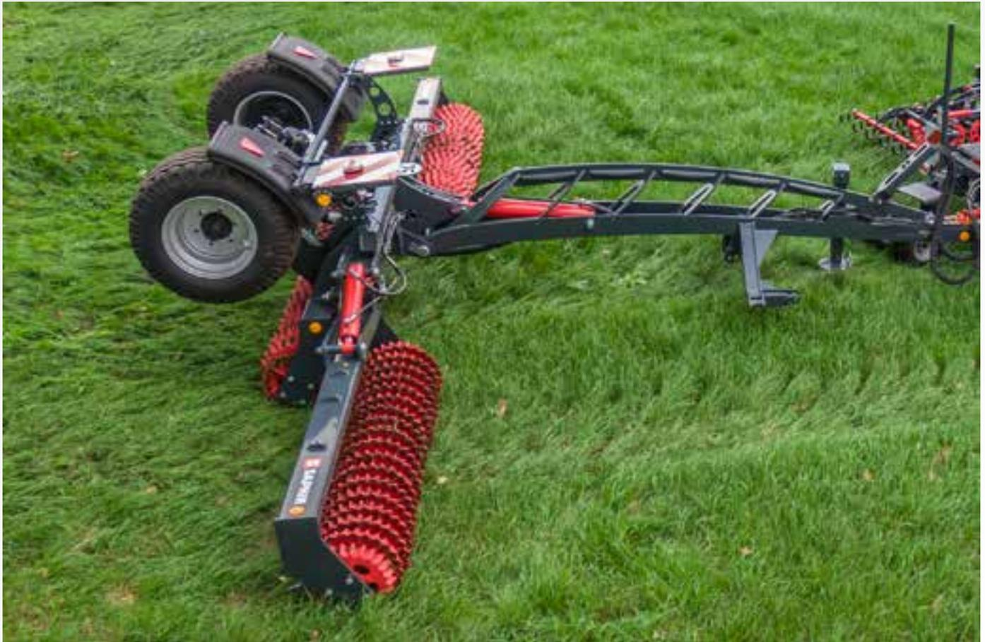
Der Einsatz der SAPHIR Ackerwalzen als Grünlandpflfegemaßnahme, besonders in der Über- und Neuansaat sorgt für eine verbesserte Wasser- und Wärmeleitung des Bodens, die Bestockung wird angeregt, der Bodenschluss der Saatkörner wird hergestellt und die Tragfähigkeit der Grasnarbe wird erheblich verbessert. Dabei bieten wir je nach Einsatzerfordernis die Walze entweder als Zahnringwalze ZR mit 450/500 mm Zahnringen oder als Cambridgewalze mit 450/470 mm Cambridgeringen an.
