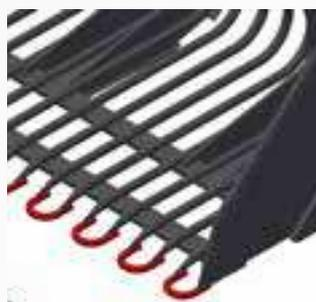
Rundbügel, empfohlen für Arbeiten auf unbefestigtem Untergrund
