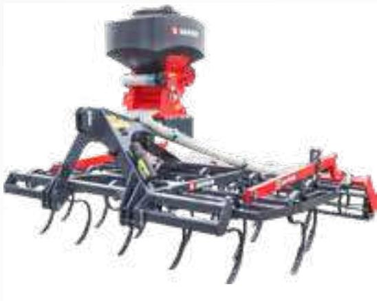
Das Modell AllStar 301 Profi hat einen durchgängigen Rahmen. Die zulässige Transportbreite von 3,0 m wird eingehalten. Das Gerät kann bereits mit Traktoren ab 44 kW / 60 PS betrieben werden. Durch die umfangreichen Sonderausrüstungen lässt sich das Gerät optimal an verschiedene Einsatzbereiche und Bodenbedingungen anpassen.
