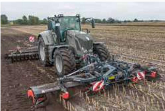
Unseren Messerwalzen lassen sich auch im Verbund mit anderen Bodenbearbeitungsgeräten, wie z.B. einer Scheibenegge oder einer Großfederzinkenegge einsetzen, um mehrere Arbeitsgänge zu kombinieren und um die Geräte noch effizienter einzusetzen.
