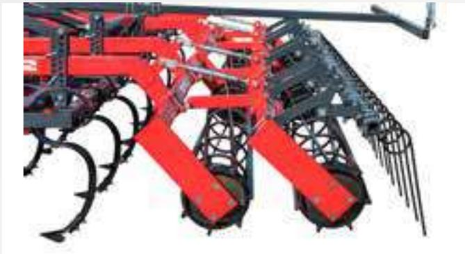
Die Doppelkrümlerwalze besteht aus zwei Krümlerwalzen mit Ø 350 mm. Sie sind zur Saatbettbereitung und mech. Unkrautbekämpfung auf mittleren bis schweren Böden vorgesehen. Durch die Schlagleisten werden die Wurzelballen von Erde befreit. Da die Rückverfestigung dieser Walze gering ist, können die Unkräuter durch einen nachfolgenden Striegel an die Oberfläche befördert werden. Der Bodendruck der hinteren Walze kann über verstellbare Spindeln eingestellt werden (optimal ca. 40% vorne / 60% hinten)
