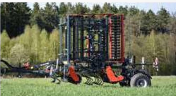
Die Modelle FineStar 505 F Profi und 605 F Profi verfügen serienmäßig über ein Transportfahrwerk mit Bereifung 400/60-15.5 und Druckluftbremsanlage.
