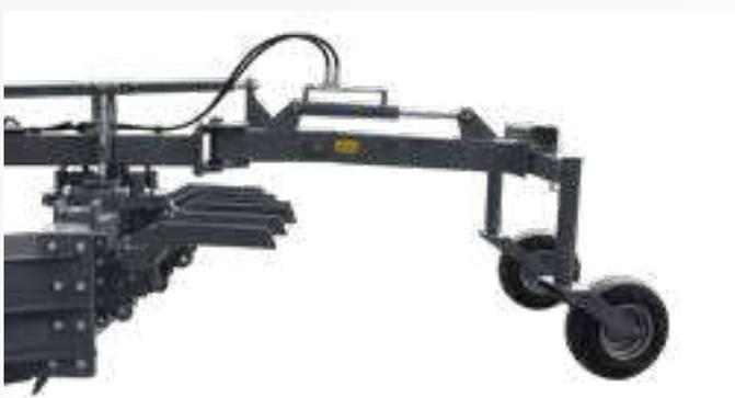
Mit der hydr. Höhenführung kann die Tiefe stufenlos eingestellt werden. Die Parallelführung sorgt für eine exakte Führung. Der integrierte Niveaueausgleich ermöglicht das Erstellen von Dachprofilen.
