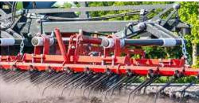
Die Belastung des Zinkenfelds durch das Eigengewicht sorgt auch auf schweren, verkrusteten Böden für eine optimale Anpassung. Die in Ketten schleppend geführten Felder werden von den Profilrohren in der idealen Position geführt.
