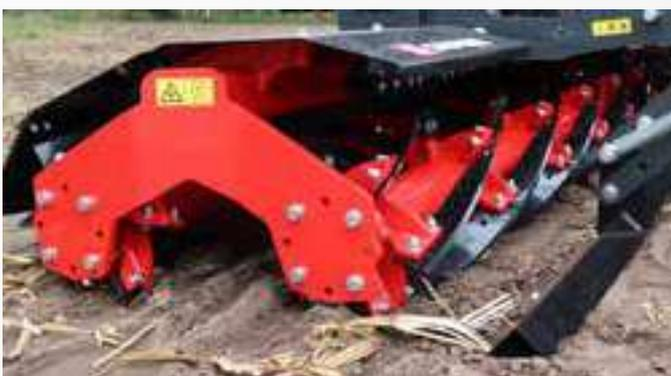
Durch die zwei entgegengerichteten Messerwalzen ergibt sich daraus das einzigartige Sinusraster, wodurch ein engmaschiges Schnittmuster entsteht. Organische Reste werden auf diese Weise effizient zerkleinert.
