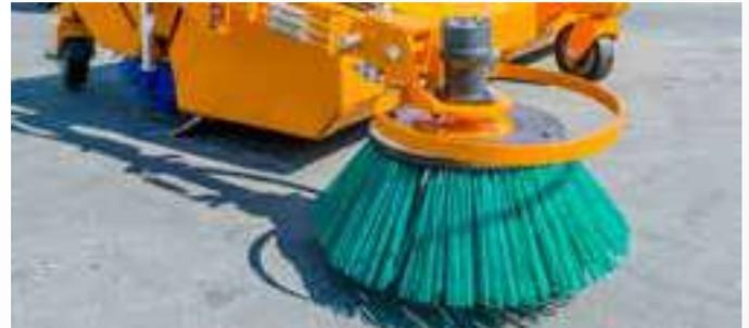
Optionaler Seitenkehrbesen mit hydraulischem Antrieb für das Reinigen an beispielsweise Straßenrändern
