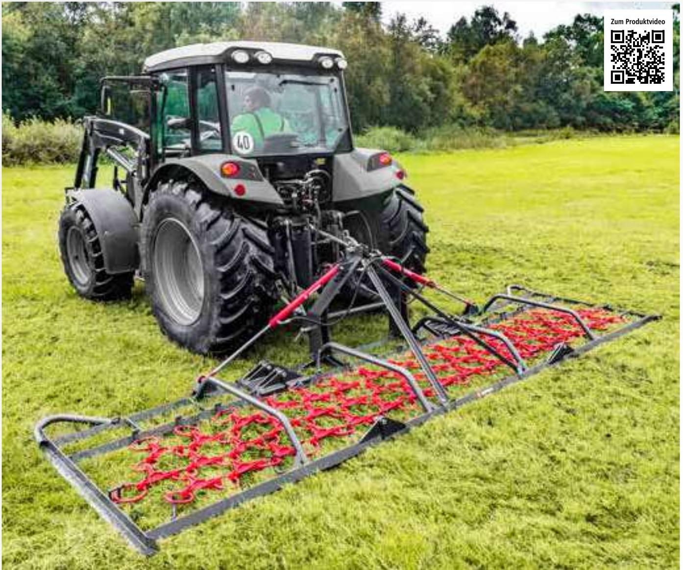
Die SAPHIR Grünlandegge Perfekt W ist mit einem dreireihig angeordneten Gußsternnetz ideal für die leichtzügige Einebnung von Maulwurfshügeln und die Verteilung von Kuhfladen, Strohmist und Gülle. Die W-Gußsterne sorgen durch das Auskämmen von abgestorbenem Gras für eine zusätzliche Belüftung der Grasnarbe.
